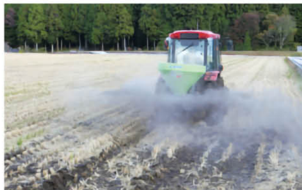
ブロードキャスターによる土づくり資材散布
